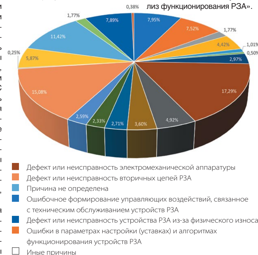
Рисунок 4. Распределение случаев неправильной работы устройств РЗА по видам технических причин
