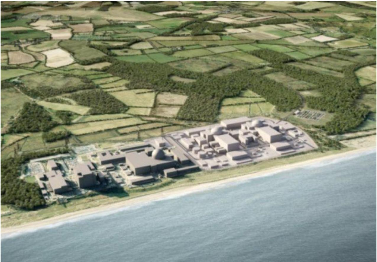
Вторая очередь – АЭС Сайзвелл В состоит из 1 энергоблока с ядерным реактором типа PWR (pressurized water reactor) – реактор с водой под давлением, мощностью 1 198 МВт. АЭС Сайзвелл В введена в эксплуатацию в 1995 г., а вывод станции из эксплуатации запланирован ориентировочно на 2035 г.
