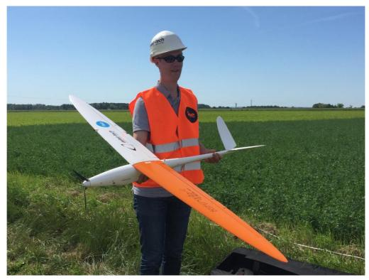
RTE занимается развитием беспилотной авиации с 2011 г., а с 2016 г. применяет БЛА для проведения локальных обследований электрической сети и прокладки кабелей, планируя в скором времени перейти к проведению инспекций ЛЭП на больших расстояниях. Преимущества использования БЛА заключаются в облегчении доступа к электросетевым объектам, и, как следствие, увеличению качества мониторинга состояния ЛЭП и снижению времени их отключения на техническое обслуживание.
