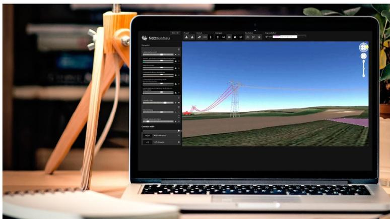
Пользователь получает возможность просмотра 3D-моделей предлагаемых компьютерной системой виртуальных маршрутов ЛЭП с разных ракурсов, как с высоты птичьего полета, так и на уровне пешехода, с возможностью выбора между различными вариантами. Предполагается, что система будет готова к использованию осенью 2017 г.
