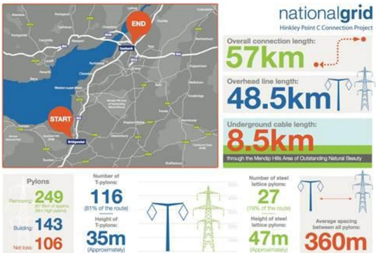
АЭС Hinkley Point C, сооружаемой французской компанией Electricite de France (EDF) в графстве Сомерсет (Somerset) на юго-западе Англии, к энергосистеме Великобритании. Проектом Hinkley–Seabank предусмотрено сооружение высоковольтной КВЛ протяженностью 57 км, из которых 48,5 км – ВЛ и 8,5 км – подземная КЛ.
