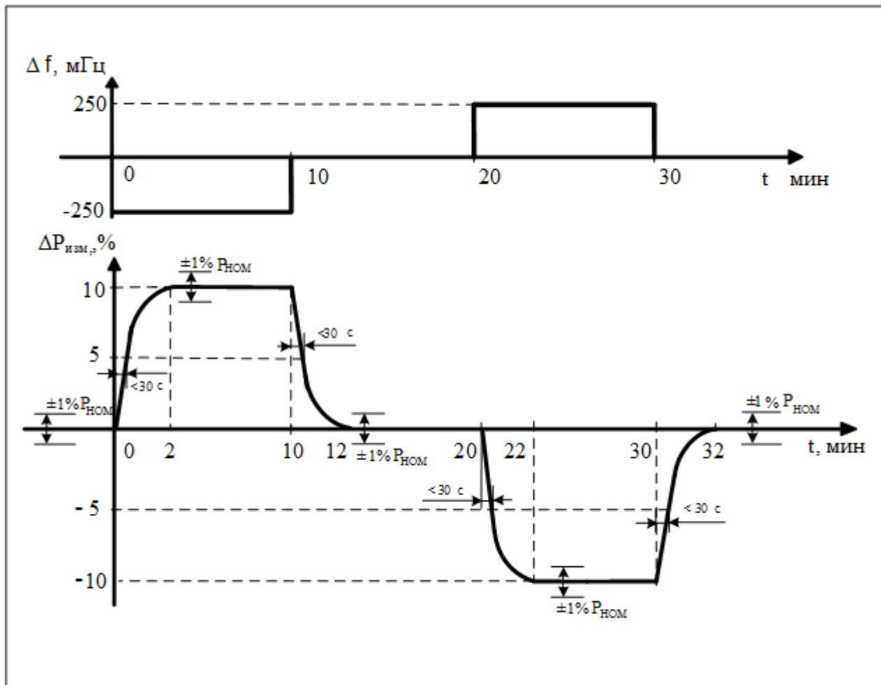
**Рис.П.6 Имитация отклонений частоты и требуемые изменения первичной мощности ПГУ (ГТУ) при  $\Delta P_{\Pi} = \pm 10\% P_{\text{ном}}$**
