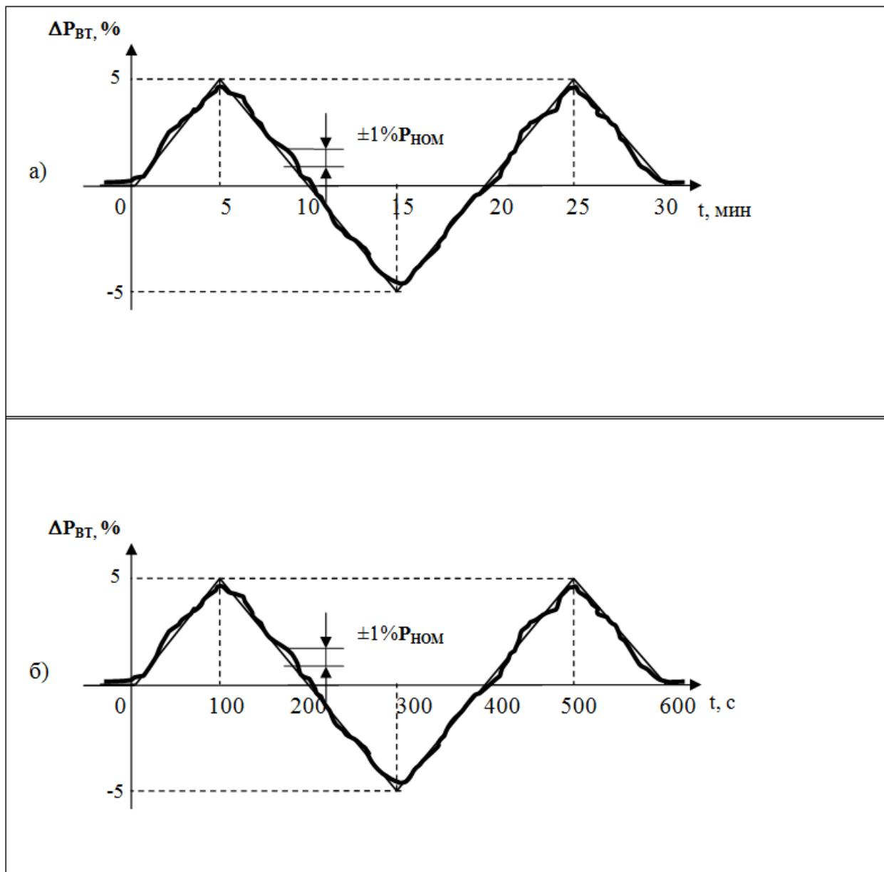
**Рис.П.7. Имитация изменений задания и требуемые изменения вторичной мощности ПГУ (ГТУ) при скорости задания изменения мощности  $1\% P_{\text{ном}}/\text{мин}$  (а) и  $3\% P_{\text{ном}}/\text{мин}$  (б)**
