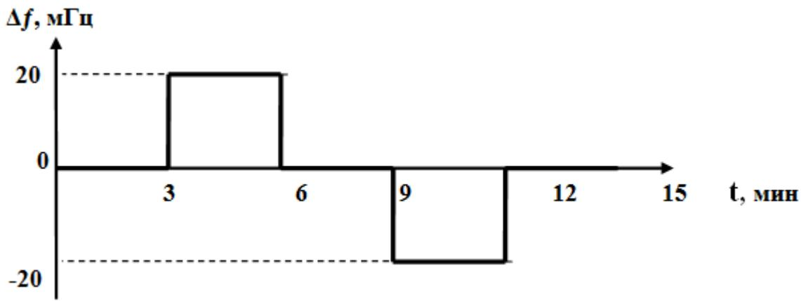
**Рис.П.2. Имитация отклонений частоты при проверке нечувствительности первичных регуляторов ПГУ (ГТУ)**
