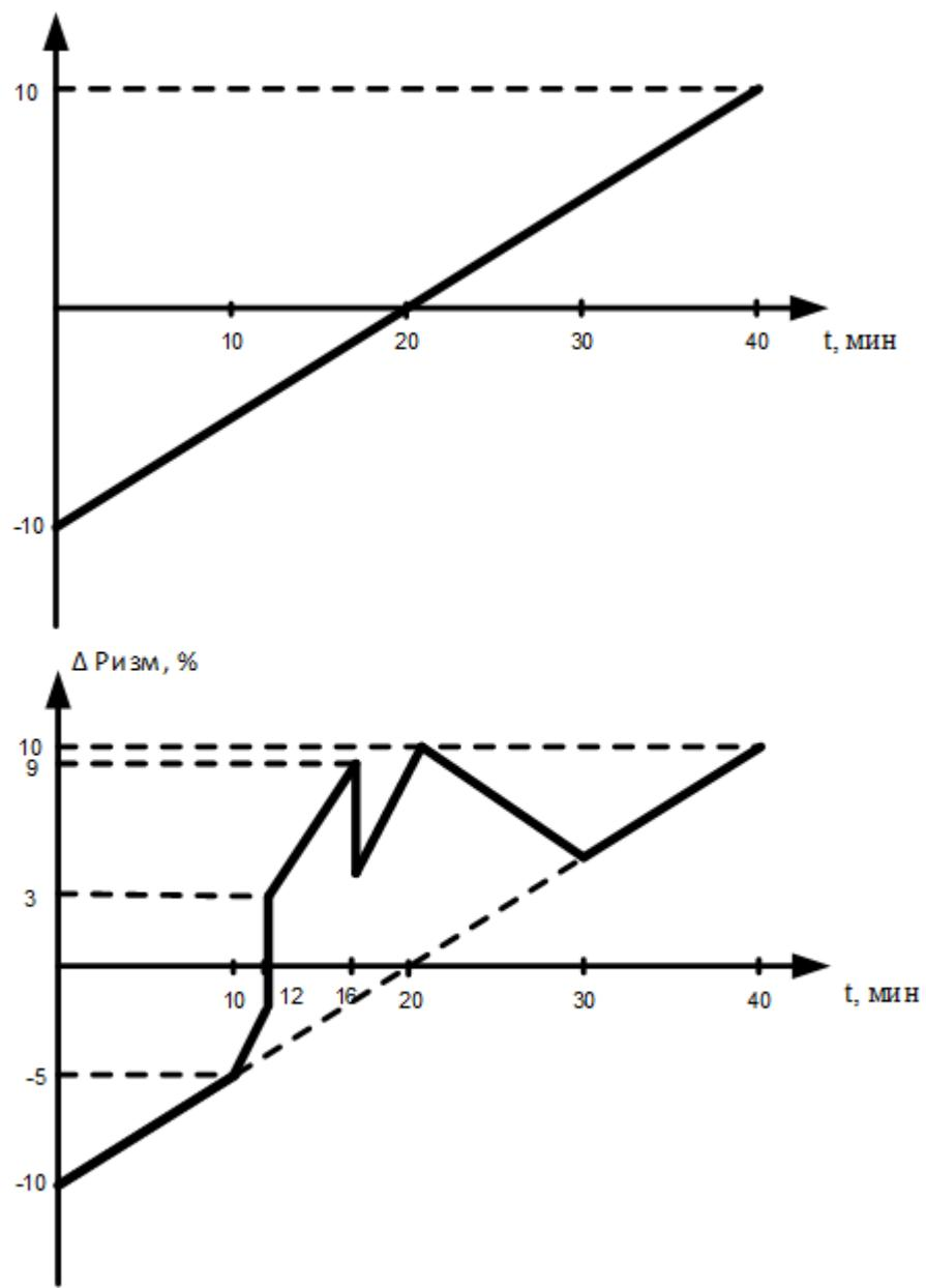
**Рис.П.10. Имитация изменений заданий вторичной мощности и отклонений частоты при изменении планового задания ПГУ (ГТУ)**
