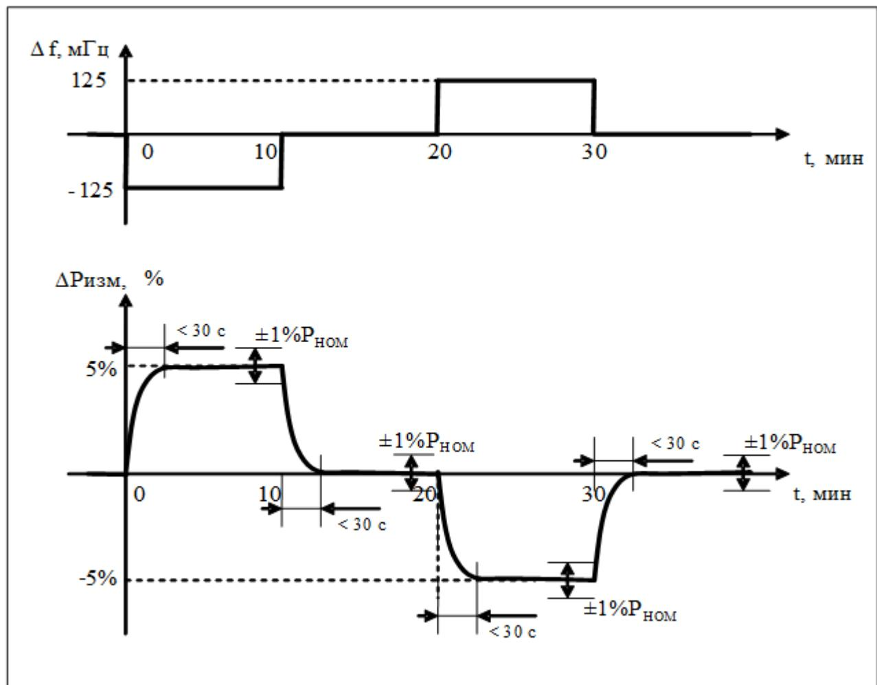
**Рис.П.5. Имитация отклонений частоты и требуемые изменения первичной мощности ПГУ (ГТУ) при  $\Delta P_{\Pi} = \pm 5\% P_{\text{ном}}$**
