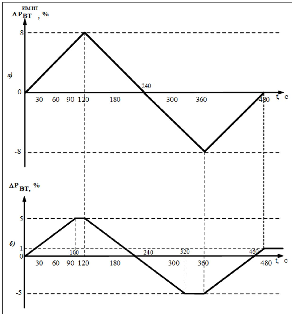
Рис.П.8. Имитация изменений задания  $\Delta P_{BT} = \pm 8\%P_{nom}$  со скоростью 4%  $P_{nom}/мин$  (а) и требуемые изменения мощности ПГУ (ГТУ) при установленных в САУМ ограничениях скорости
