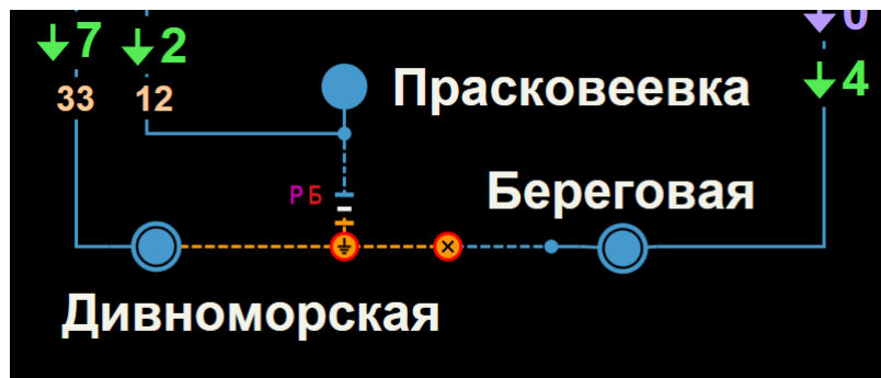
Рисунок П.76. Отображение на схеме ДЩ разрыва линии и установки ПЗ на один участок ЛЭП с подачей напряжения на другой участок ЛЭП
