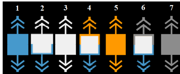
Рисунок 39. Топологические состояния выкатного выключателя
