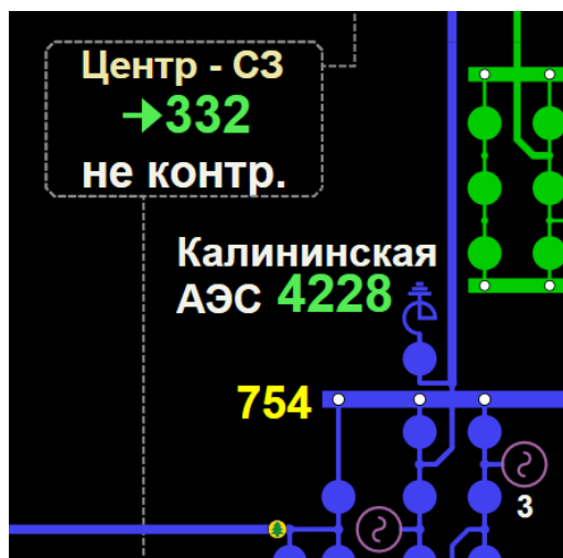
Рисунок П.64. Контроль перетока активной мощности не осуществляется
