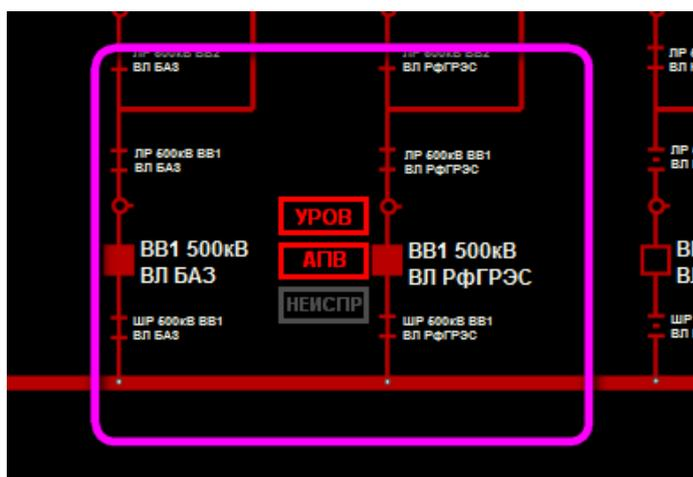
Рисунок 76. Отображение табло АПТС выключателя на графической схеме энергообъекта
