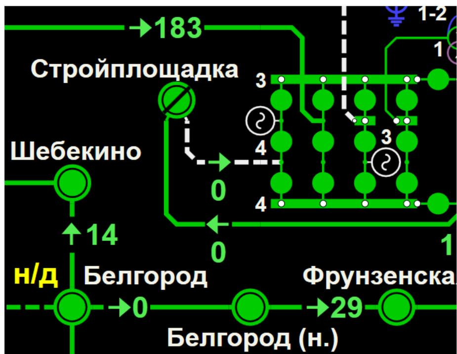
Рисунок 73. Визуализация раздельной работы СШ/С на ПС 330 кВ Стройплощадка
