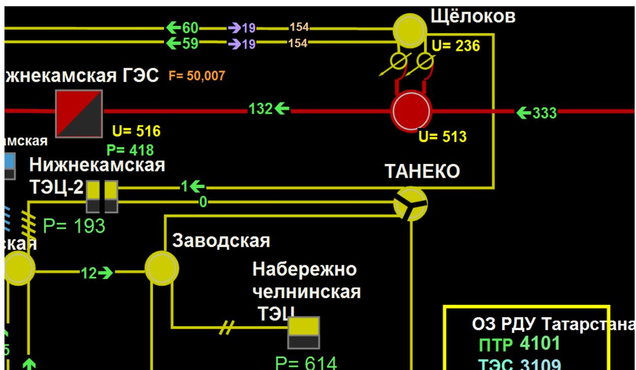
Рисунок 72. Визуализация раздельной работы СШ/С на ПС 220 кВ ТАНЕКО
