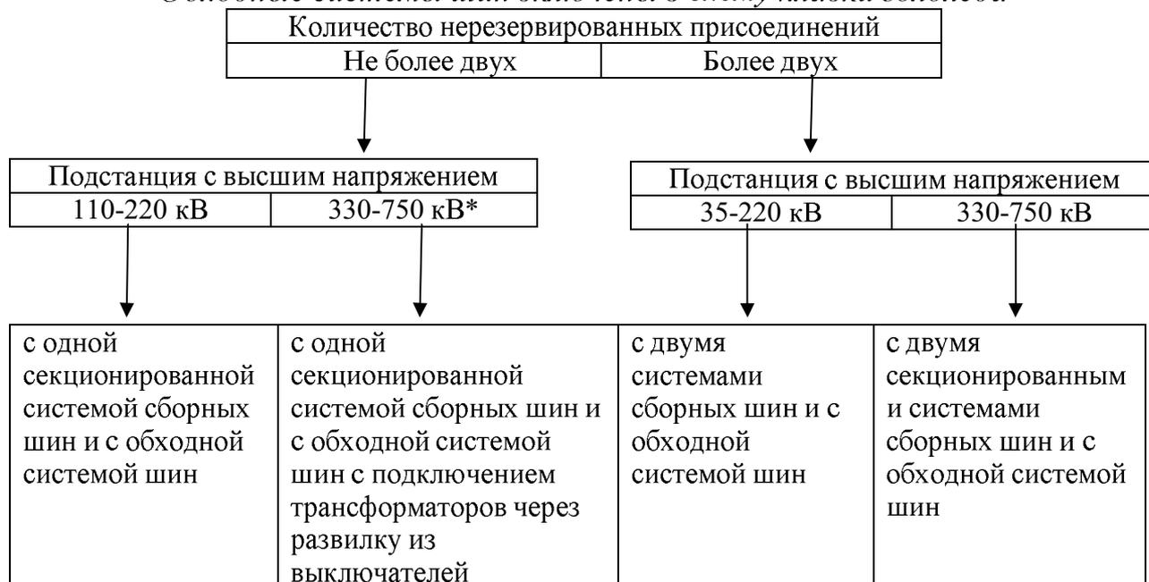
\* РУ 35 - 220 кВ подстанции с высшим напряжением 330 - 750 кВ (т.е. сторона среднего напряжения)
