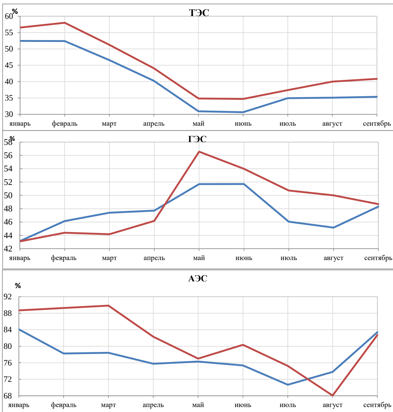
Рис 2.4. Динамика изменения коэффициентов использования установленной мощности ТЭС, ГЭС, АЭС, ВЭС, СЭС ЕЭС России ежемесячно за 9 месяцев 2020 и 2021 годов
