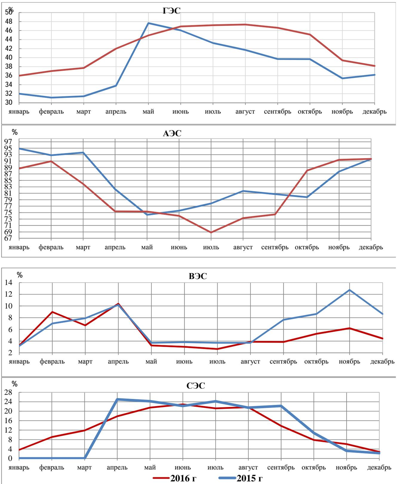
**Рис.2.1.3.1. Динамика изменения коэффициентов использования установленной мощности ТЭС, ГЭС, АЭС, ВЭС, СЭС ЕЭС России за 2015-2016 годы**
