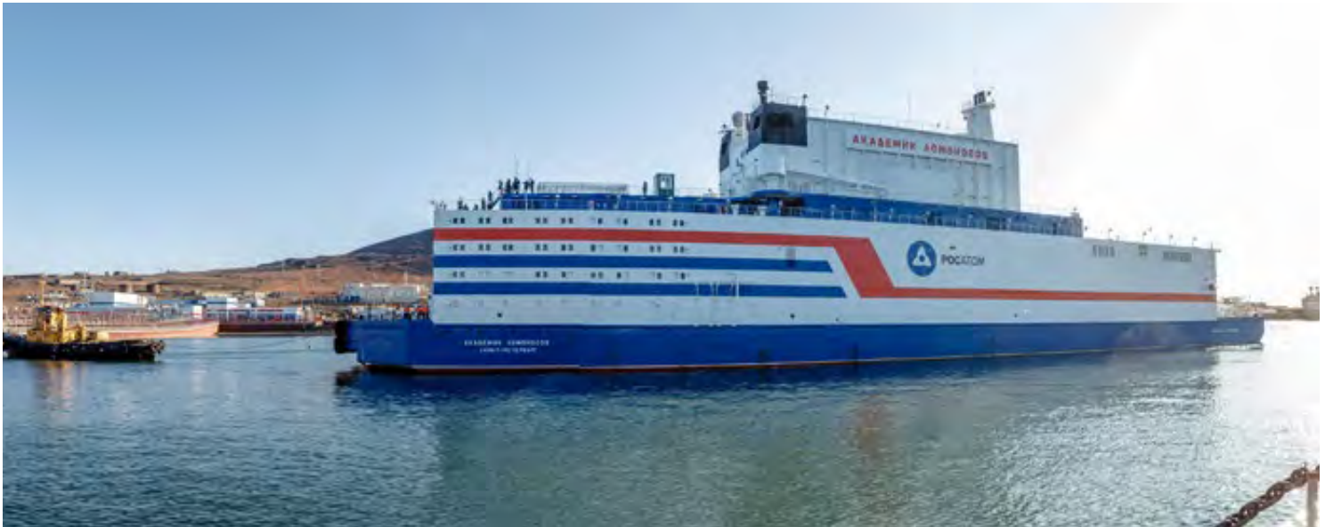
Работающий в составе плавучей атомной тепловыделяющей станции (ПАТЭС) плавучий энергетический блок «Академик Ломоносов» в городе Певек на Чукотке может обеспечивать выдачу до 70 МВт электроэнергии и до 50 Гкал/ч тепловой энергии
