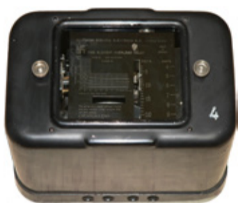
Шведское индукционное реле RI, которое изготавливалось с 1919 года, стало прототипом первого отечественного устройства РЗА ИТ-80
