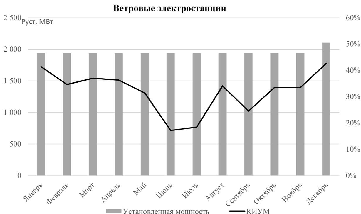
Рисунок XII.2 – КИУМ и установленная мощность ветровых электростанций в 2022 году
