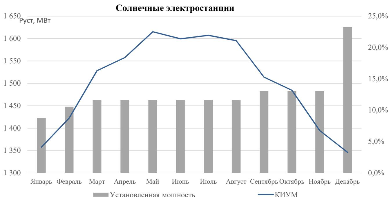
Рисунок ХIII.1 – КИУМ и установленная мощность солнечных электростанций в 2021 году
