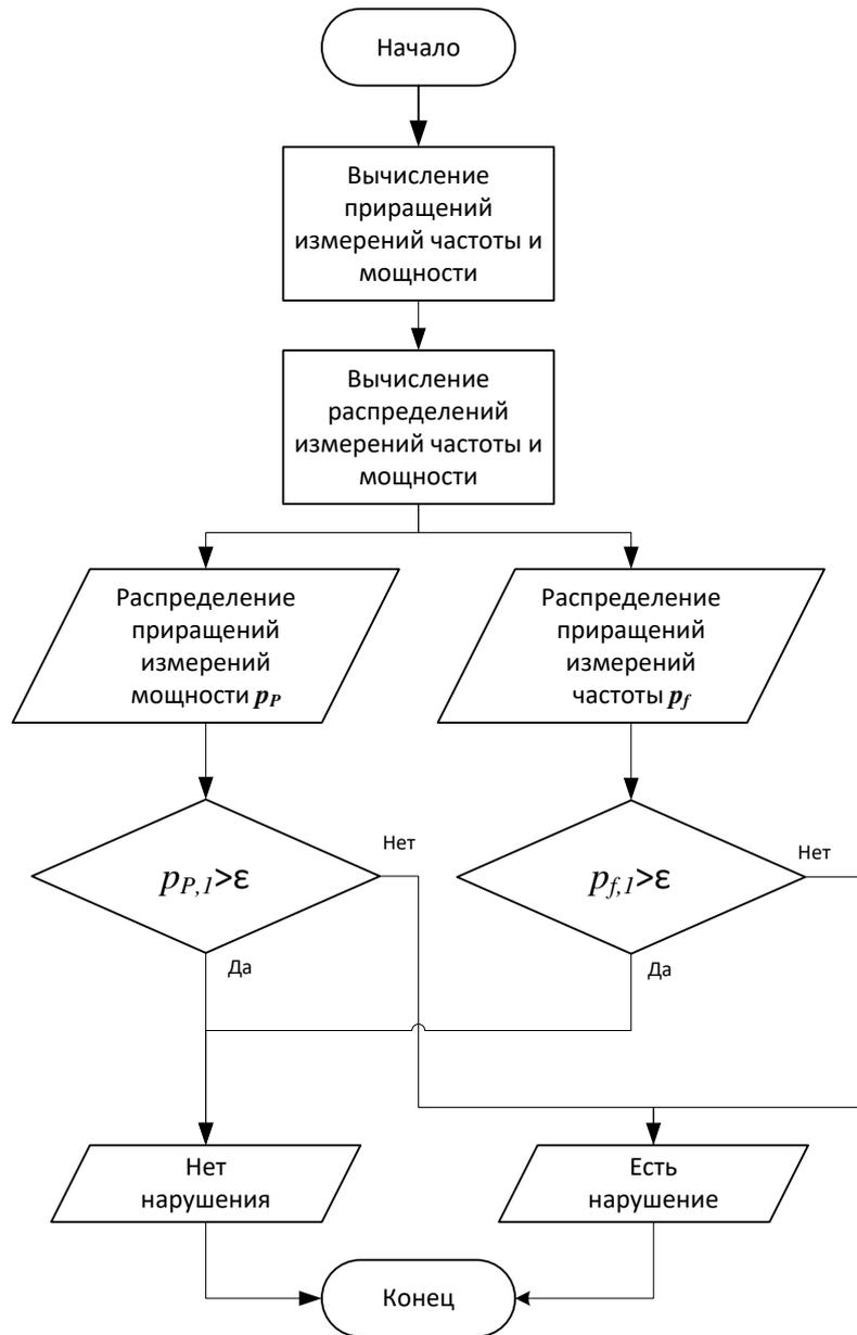
Рисунок 3. Блок-схема алгоритма "Несоответствие дискретности измерений требуемым"
