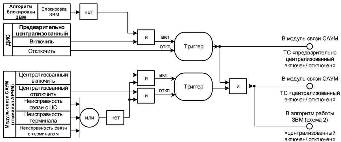
Рисунок 1 — Алгоритм включения/отключения централизованного режима генерирующего оборудования ТЭС
