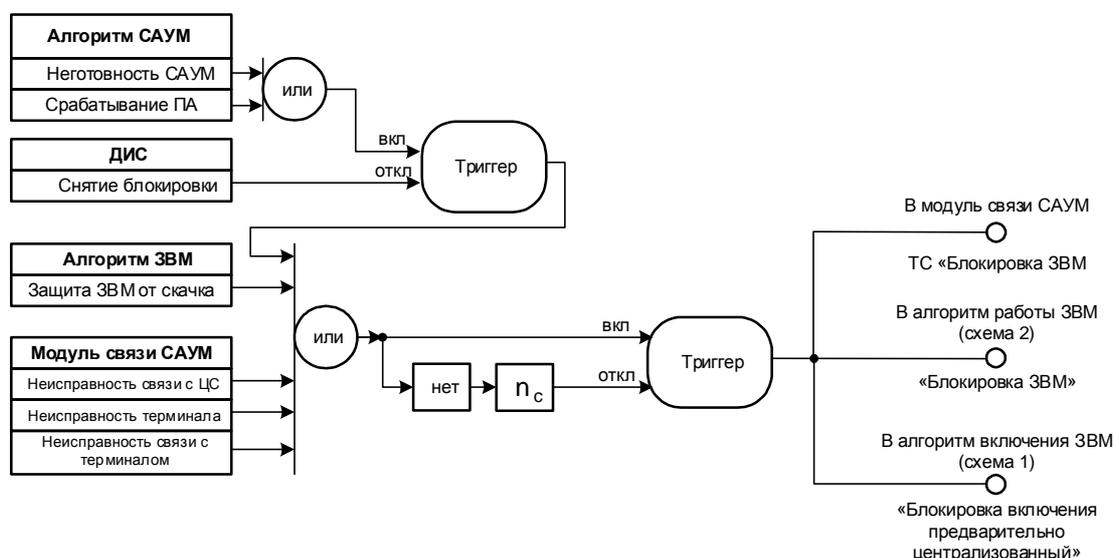
Рисунок 3 — Схема блокировки централизованного управления (блокировки ЗВМ)
