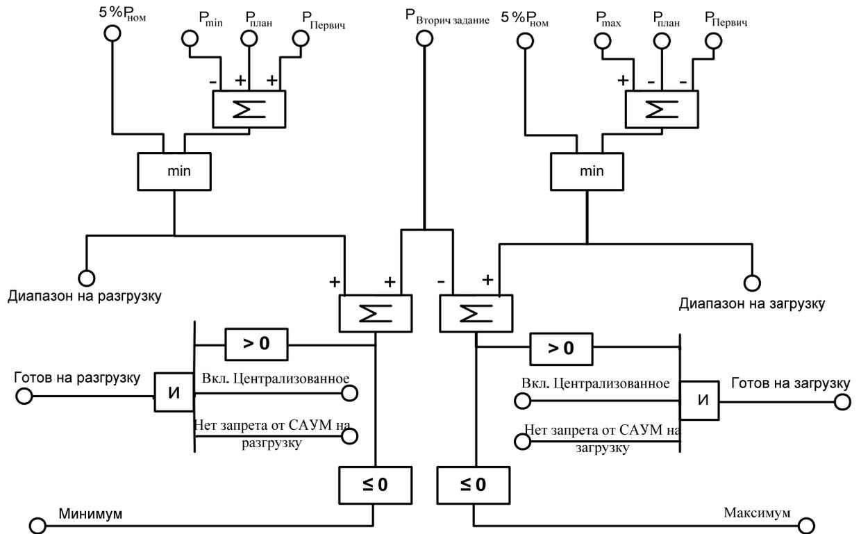
**Схема 4.** Определение диапазона вторичного регулирования и готовности загрузки/ разгрузки ЭБ.
