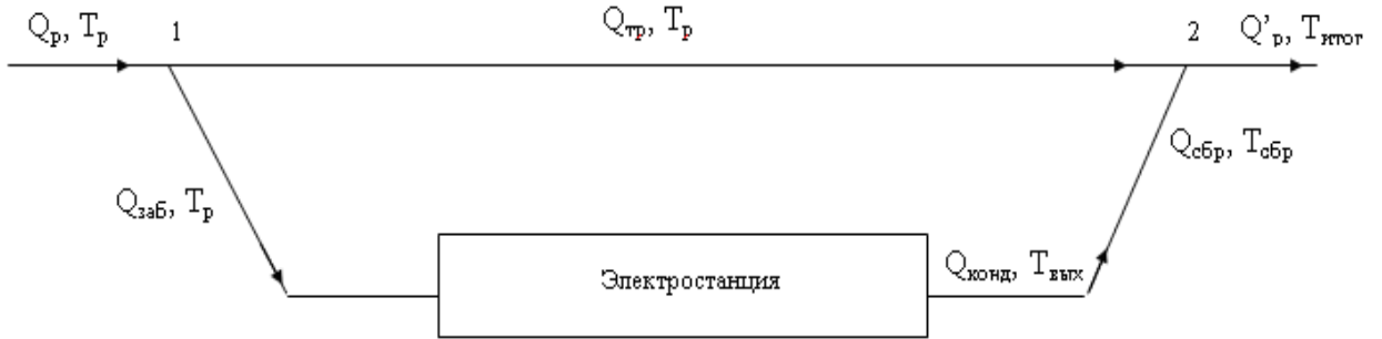
Рис. 11.9. Принципиальная схема технического водоснабжения
