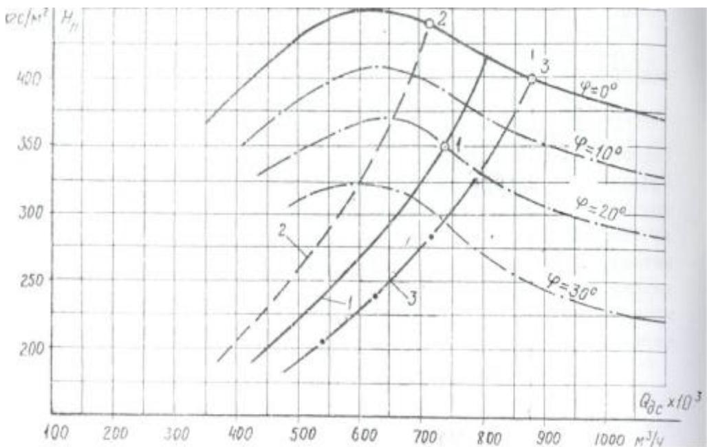
Рис. 14.1. Ограничение паропроизводительности котла из-за нехватки тяги:
