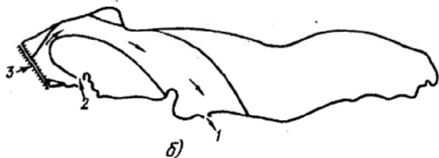
1 – водозаборное сооружение; 2 – водовыпускное сооружение; 3 – плотина
