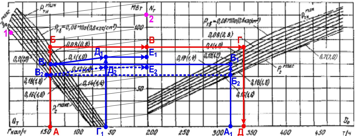
Рис. 12.4. Диаграмма режимов турбины типа «Т», вариант 1
