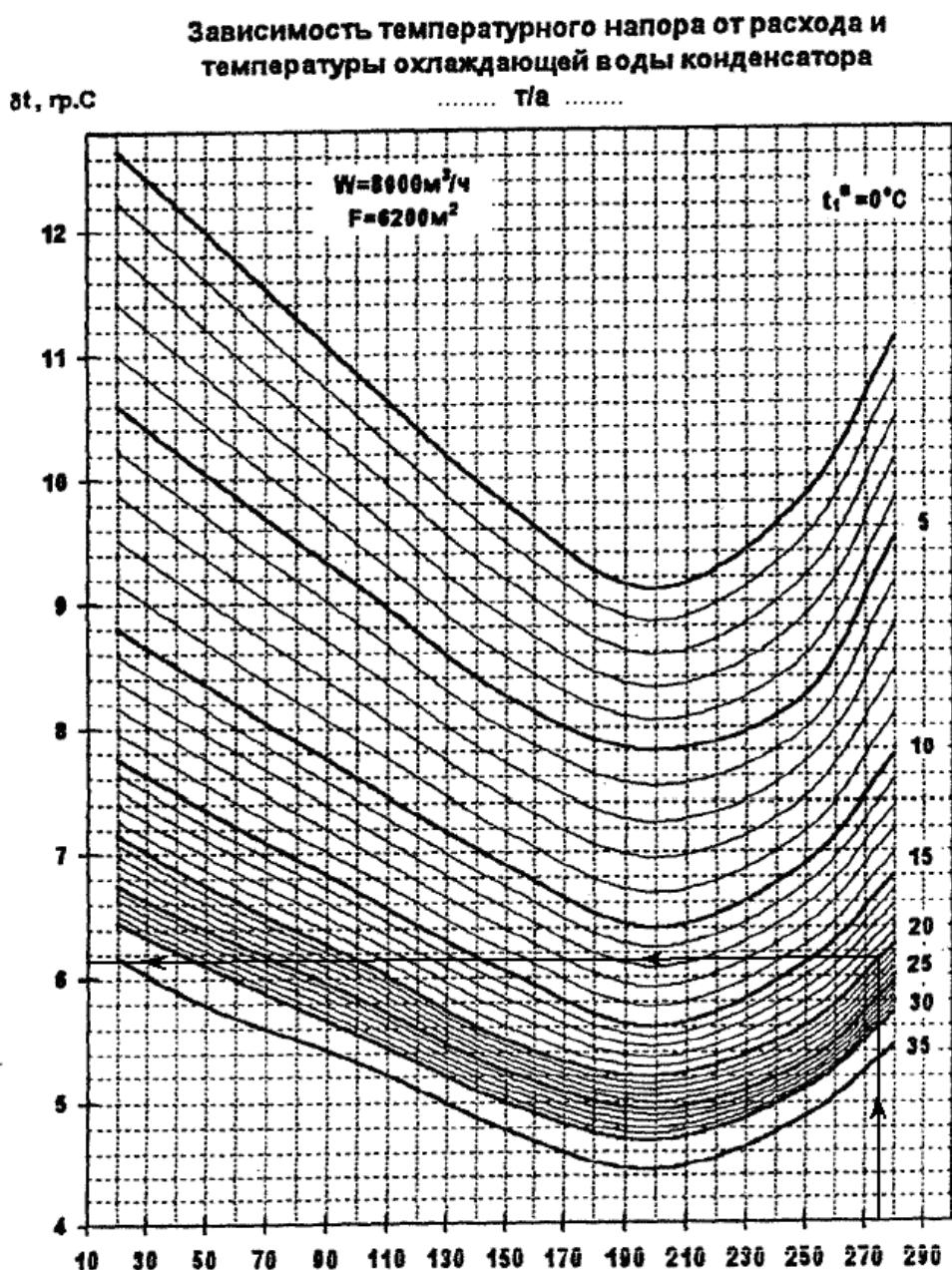
Рис. 11.2. Пример определения температурного напора по характеристике конденсатора.
