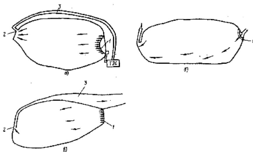
Рис.11.6. Схемы расположения (а, б, в) водозаборных и водовыпусканых сооружений на наливных водохранилищах (1 – водовыпускное сооружение; 2 – водозаборное сооружение; 3 – водоотводящий канал)
