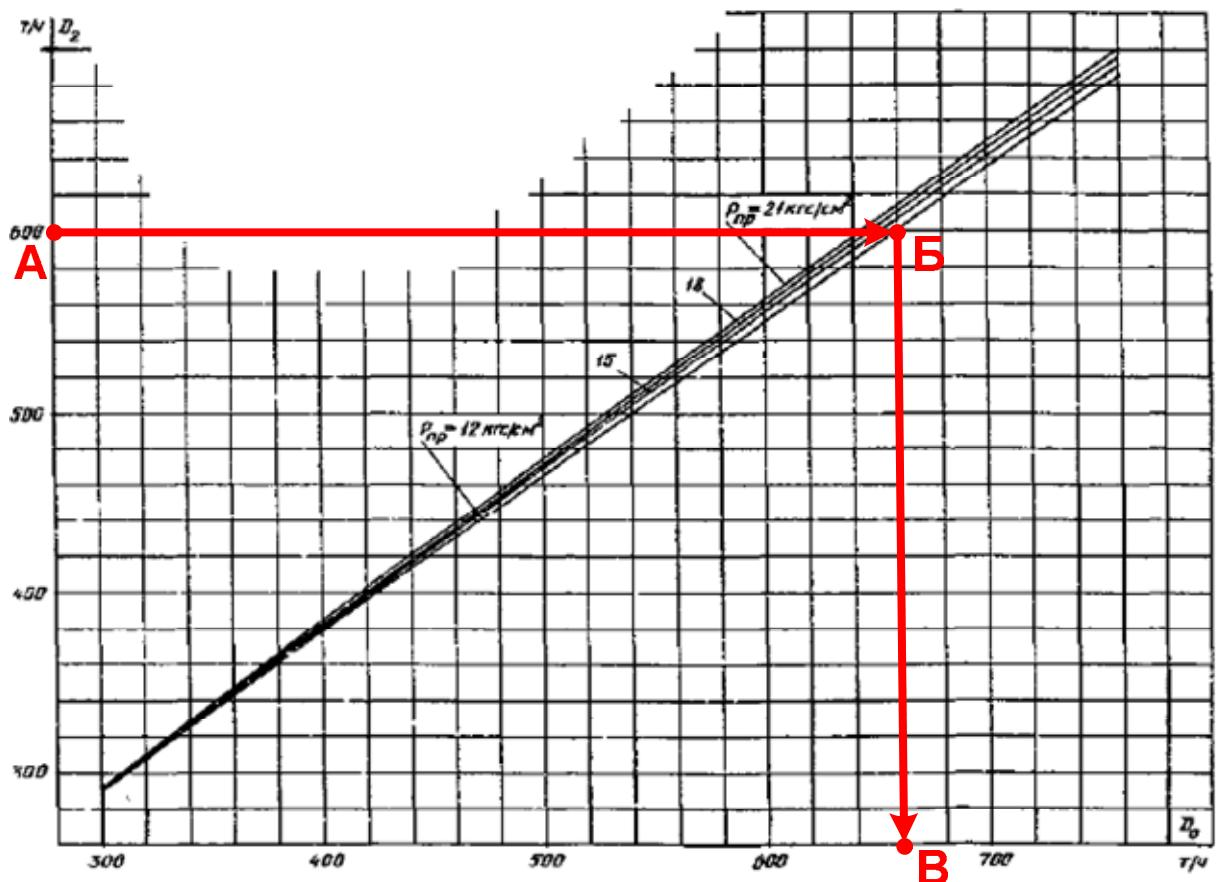
Рис. 12.3 Зависимость расхода пара в голову турбины от расхода пара на выходе из последней ступени (на примере турбины Р-100-130/15).
