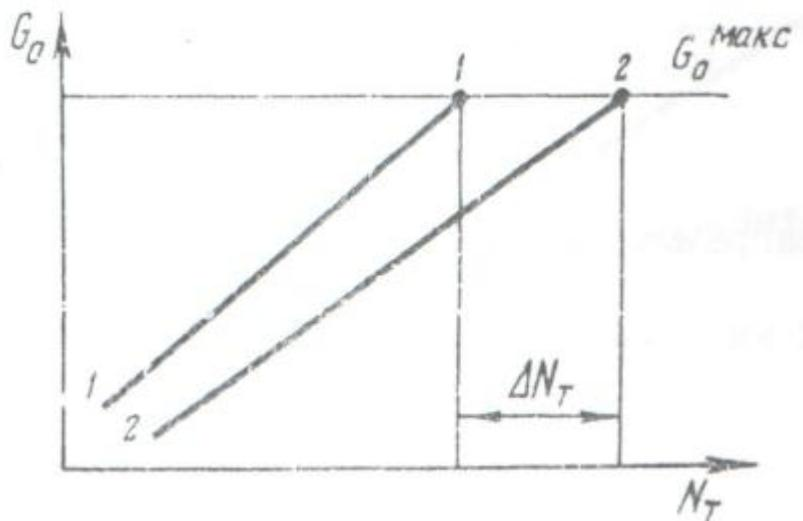
Рис. 12.6. Зависимость электрической мощности турбины типа «К» от расхода пара в голову при нормальном (линия 2-2) и ухудшенном (линия 1-1) вакууме,
