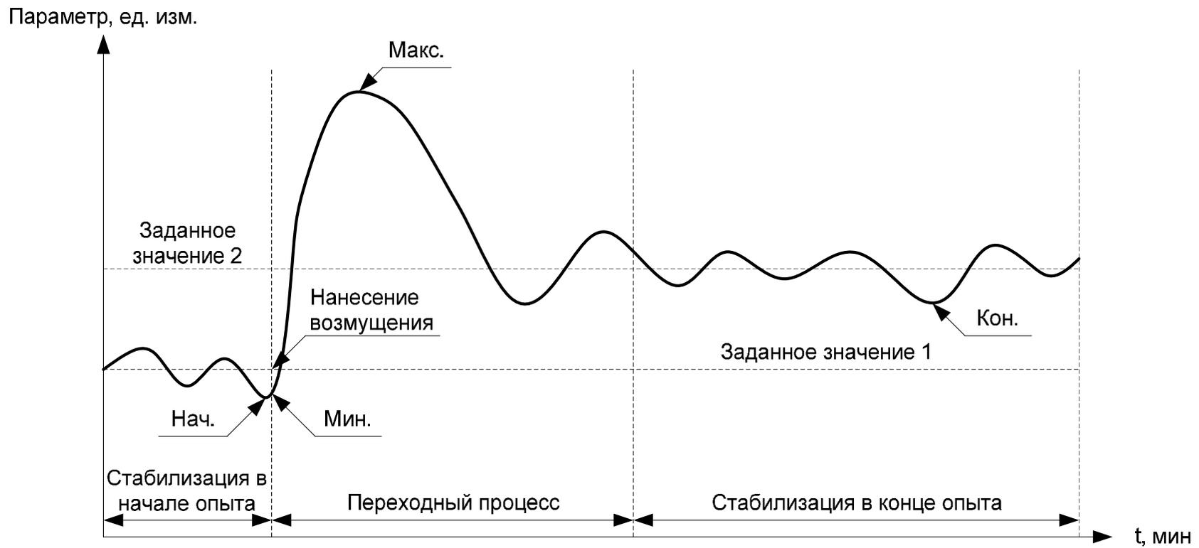
**Рисунок Е.2. Уточняющий рисунок по заполнению бланка-таблицы зарегистрированных технологических параметров, которые изменяются в зависимости от нагрузки в регулировочном диапазоне генерирующего оборудования**
