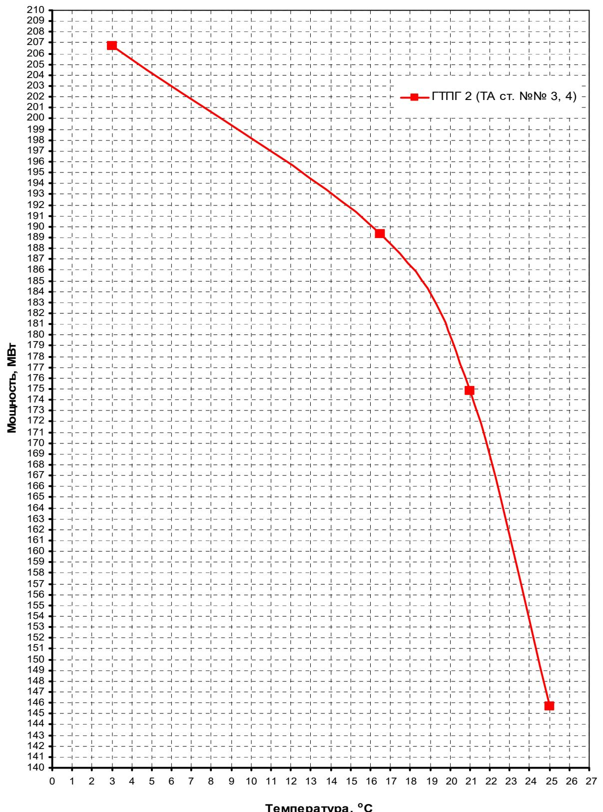
При расчетной температуре наружного воздуха в июле месяце 25°C располагаемая мощность турбоагрегатов ст. №№ 3, 4 составит 83,1 МВт и 62,6 МВт соответственно; временные ограничения установленной мощности сезонного действия, обусловленные недостаточным количеством градирен по проекту (код 341) составят:
