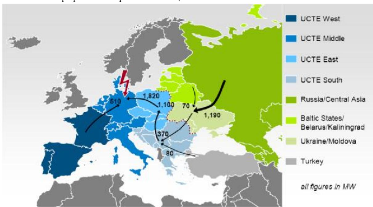
*Рисунок 7. Регулируемый переток после аварийного отключения 3000 МВт в UCTE*
