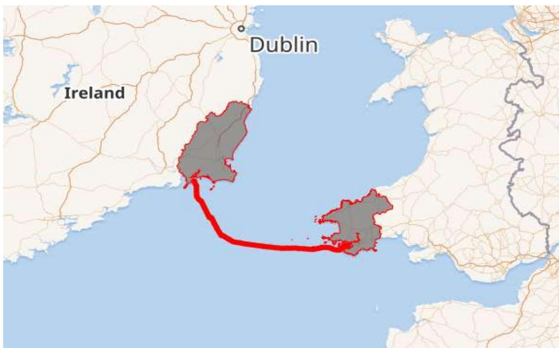
Строительство Greenlink началось в январе 2022 г. опытная эксплуатация – в феврале 2025 г. В рамках проекта Siemens Energy построила две HVDC ППС, а Sumitomo Electric поставила HVDC кабели с изоляцией из сшитого полиэтилена. Кабельная сеть Greenlink включает 24 км наземных КЛ в Ирландии и 6 км в Уэльсе, а также 160 км подводных КЛ, проложенных через Ирландское море.
