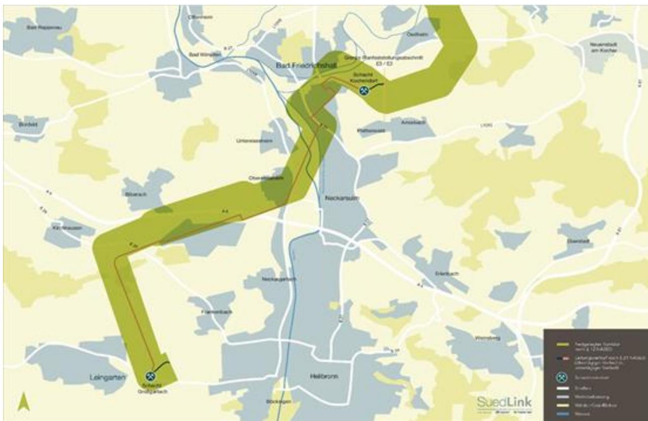
Целью сооружения SuedLink является обеспечение передачи «чистой» электроэнергии, вырабатываемой ветропарками на севере Германии, в крупные центры потребления на юге страны. Полностью ввести в эксплуатацию соединение SuedLink планируется в 2028 г.
