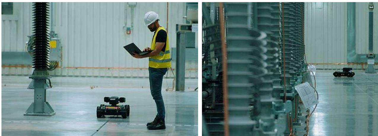
В пределах станционного помещения робот, который оснащен специальными RGB камерами высокого разрешения, тепловизором и специальными датчиками для мониторинга температуры, относительной влажности воздуха и освещенности в помещении ППС, а также микрофоном, установленными на высокоточный поворотно-наклонный блок, может передвигаться самостоятельно или управляться оператором дистанционно, что обеспечивает возможность проведения инспекции оборудования под напряжением.
