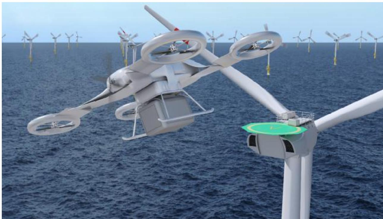
По мнению EnBW, применение грузовых дронов для перевозки инструментов и материалов непосредственно на вершину 100-метровой ветровой турбины позволит отказаться от использования специальных кранов. А применение пассажирских дронов для доставки специалистов для обслуживания ветровых турбин на объекты избавит обслуживающий персонал от двухнедельных смен с ночевками в открытом море.
