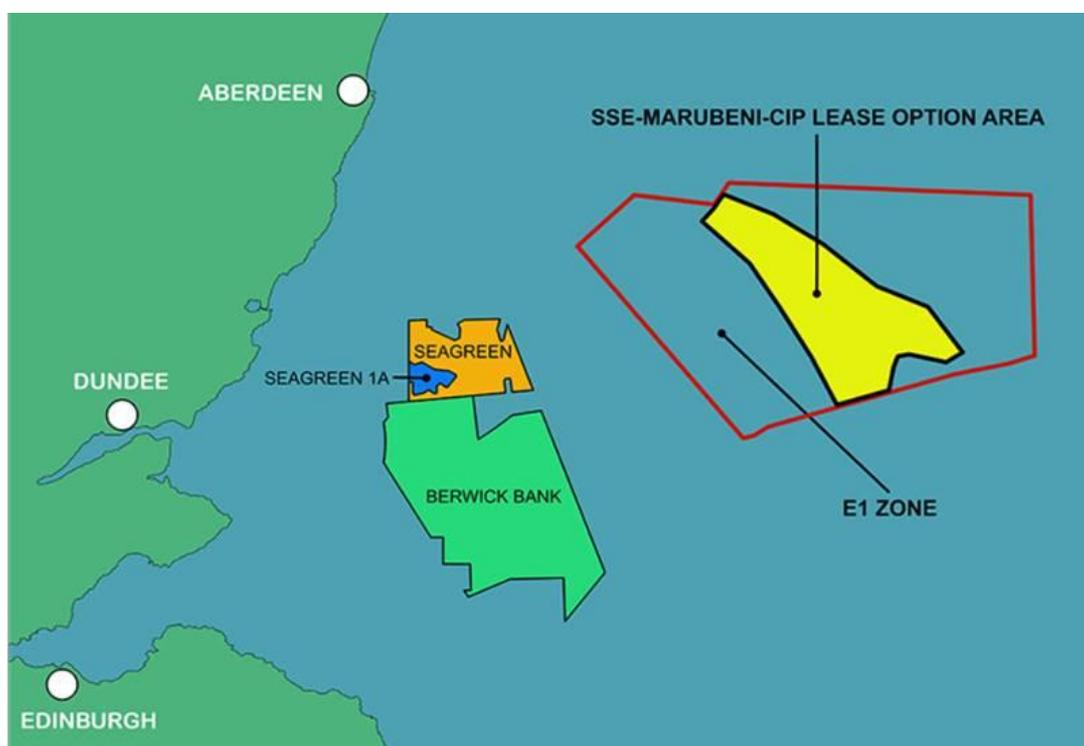
Средняя глубина моря в зоне проекта строительства комплекса ветровой генерации, реализуемого SSE-Marubeni-CIP, составляет 72 м, что делает ее подходящей для размещения плавучих ветровых турбин, суммарная установленная мощность которых может составить до 2,6 ГВт. Этого достаточно для обеспечения электроснабжения почти 4,3 млн шотландских домохозяйств и позволит на ≈5 млн тонн сократить ежегодные выбросы вредных веществ.
