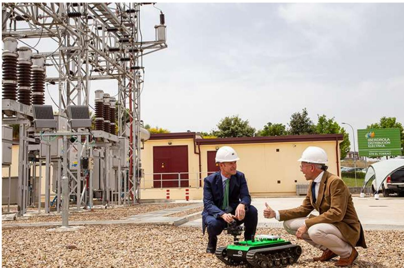
Робот, оснащенный двумя видекамерами высокого разрешения и тепловизором, способен передавать полученные данные в режиме реального времени в Центр управления Iberdrola в Мадриде (la central de Iberdrola Renovables), используя технологию 5G, предоставленную партнером проекта Orange España<sup>9</sup>, которая также позволяет, при необходимости, осуществлять ручное управление роботом.
