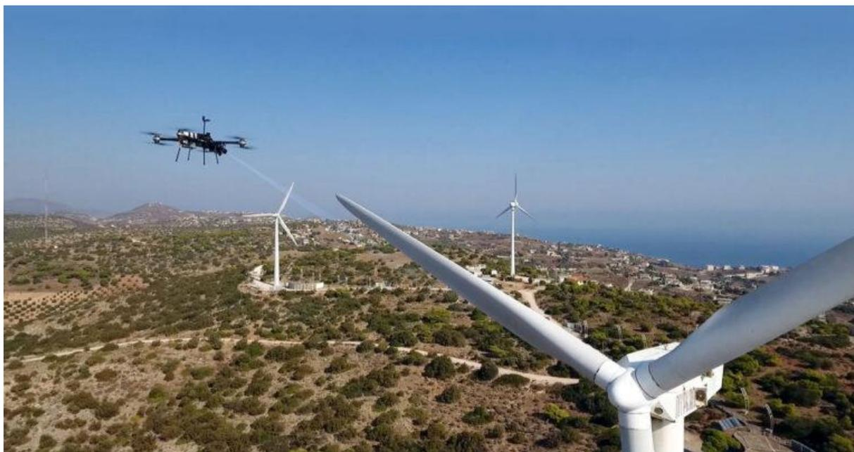
Дроны и программное обеспечение Dhalion позволяют проводить мониторинг состояния лопастей ветровых турбин с последующей обработкой полученного массива данных для выявления потенциальных неисправностей, не доводя их до критического уровня, что дает возможность инженерам и обслуживающему персоналу Enel Green Power выполнять своевременное профилактическое обслуживание ветровых турбин, сократить время простоя и снизить эксплуатационные расходы.
