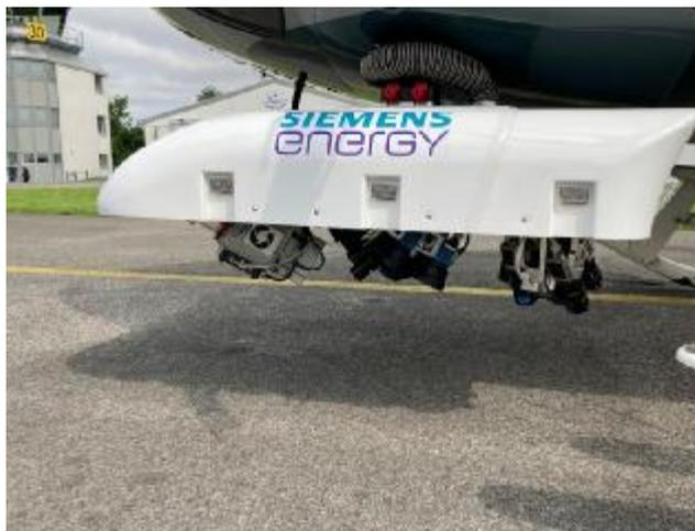
Система SIEAERO, оснащённая 19 камерами и датчиками лазерного 3D-сканирования, всего за один пролет вдоль трассы ВЛ способна собрать все необходимые данные – до 12 000 изображений и подробных 3D-данных в объеме до 300 ГБ на каждый километр ВЛ. ПО SIEAERO позволяет обработать и проанализировать такое количество данных всего за несколько часов.
