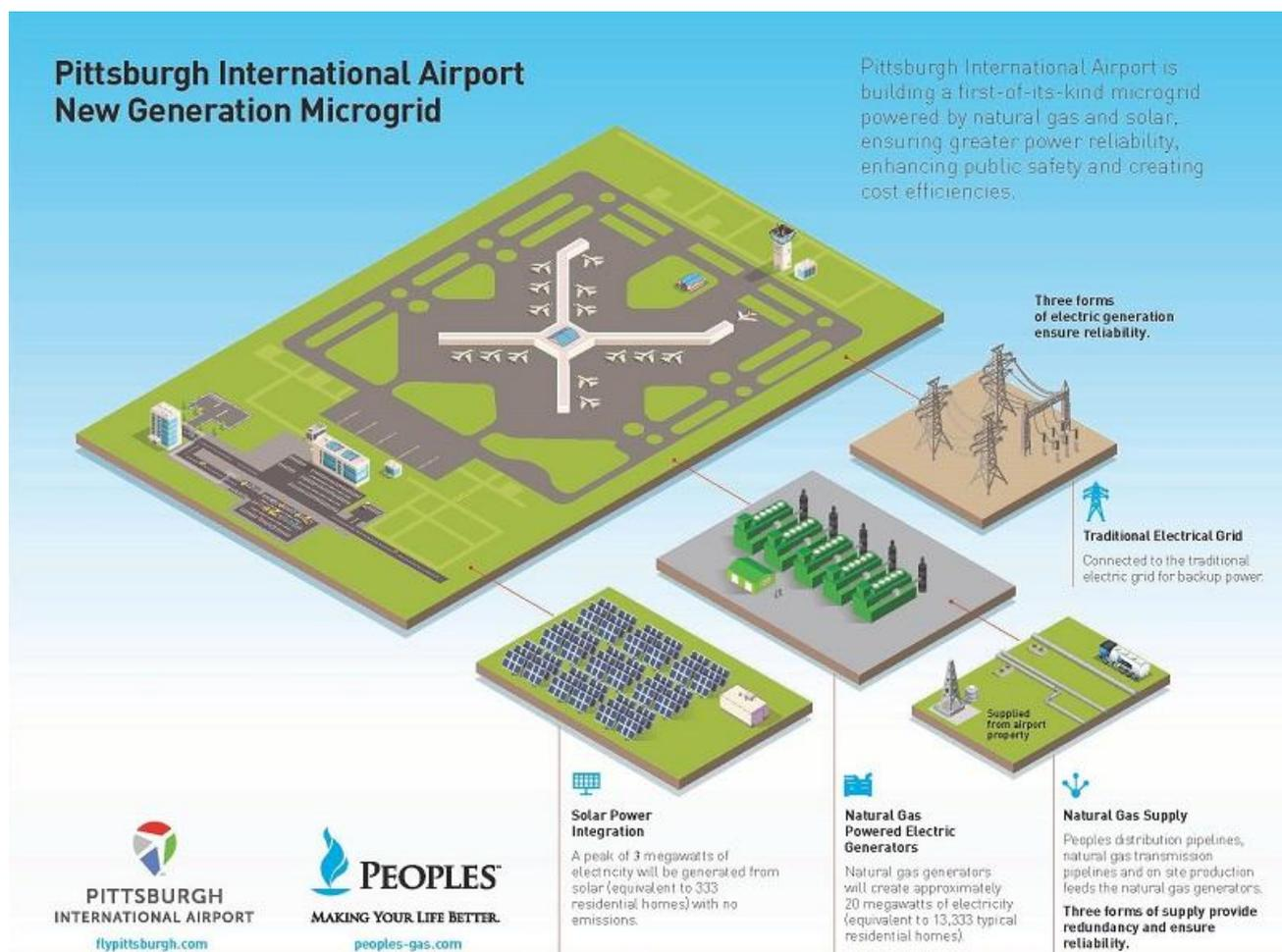
Микросеть, в составе 5 газопоршневых установок Jenbacher мощностью 4 МВт каждая и 9 360 солнечных панелей суммарной выходной мощностью свыше 20 МВт способны обеспечить энергоснабжение более 13 тыс. жилых домов. В настоящее
