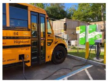
Летом текущего года за 30 сессий общей продолжительностью свыше 50 часов электробус Saf-T-Liner C2 Jouley<sup>12</sup> компании Thomas Buses<sup>13</sup>. оснащенный аккумуляторной системой Proterra Powered<sup>14</sup> энергоемкостью 160 кВт\*ч, которая поддерживает технологию реверсивной зарядки/разрядки Vehicle-to-Grid (V2G), выдал в региональную сеть общего пользования в операционной эоне National Grid в часы пикового спроса порядка 3 МВт\*ч электроэнергии.
