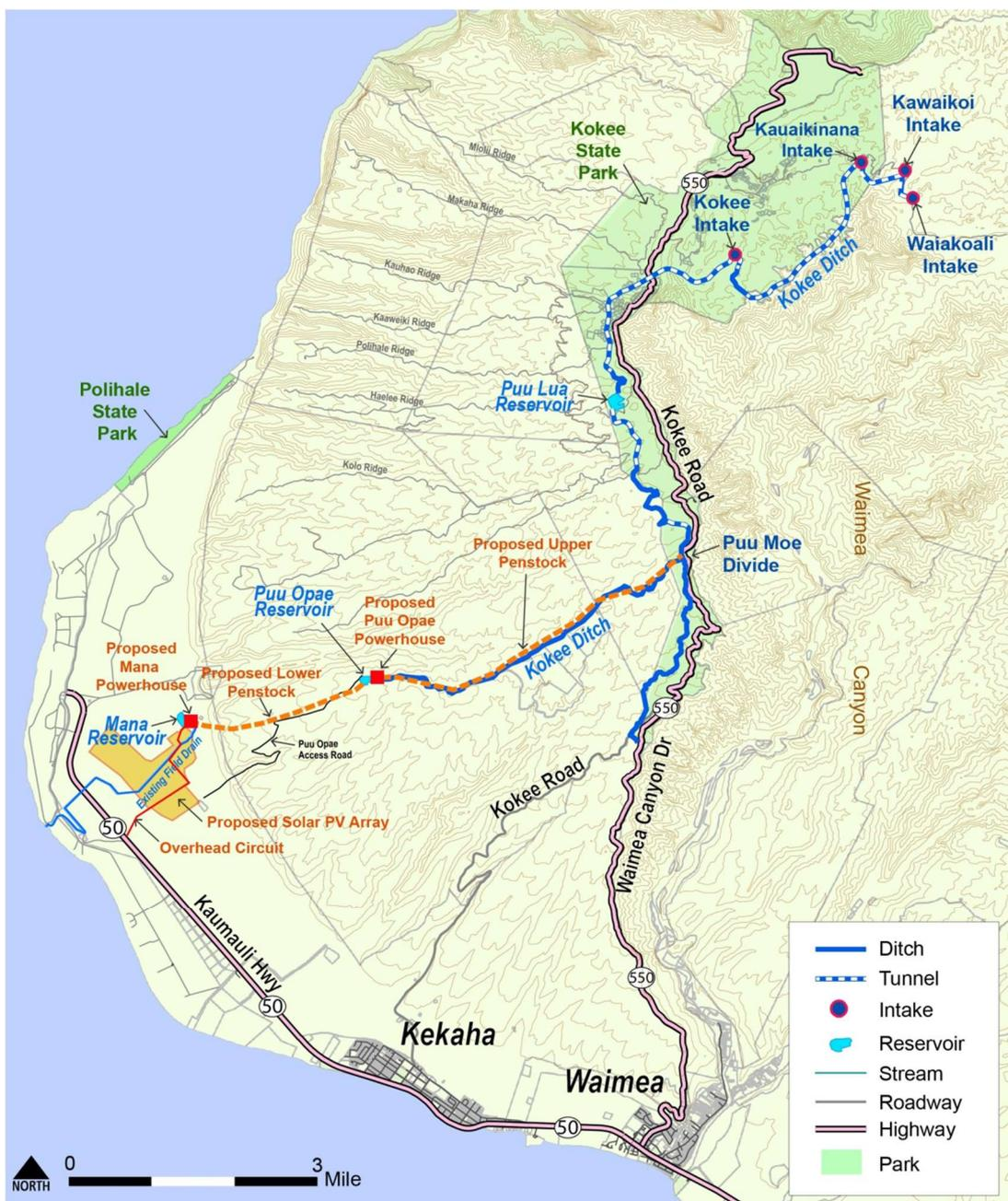
Проектом энергокомплекса (West Kauai Energy Project) предусмотрено строительство в низине о. Кауаи СЭС мощностью 35 МВт на базе фотоэлектрических
