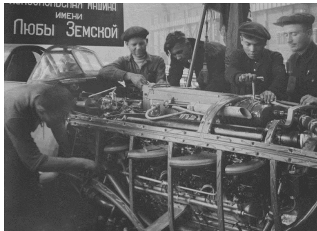
Сборка винтомоторной группы на сверхплановой комсомольской машине им. Любы Земской
