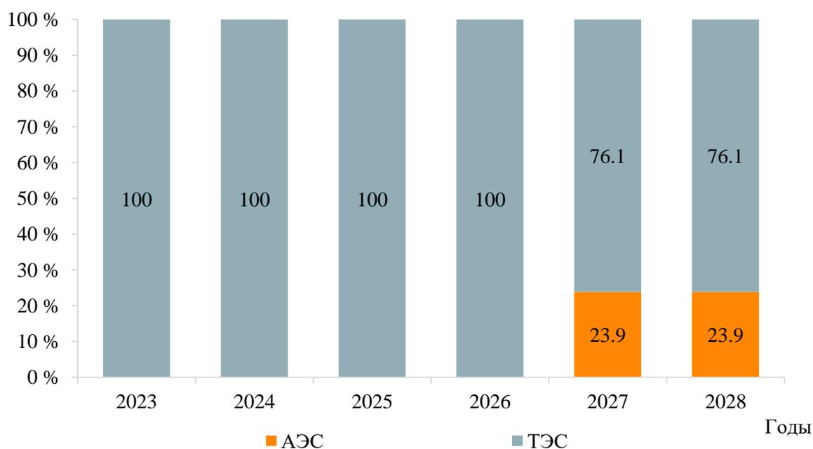
Рисунок 5 – Структура установленной мощности электростанций энергосистемы Томской области
