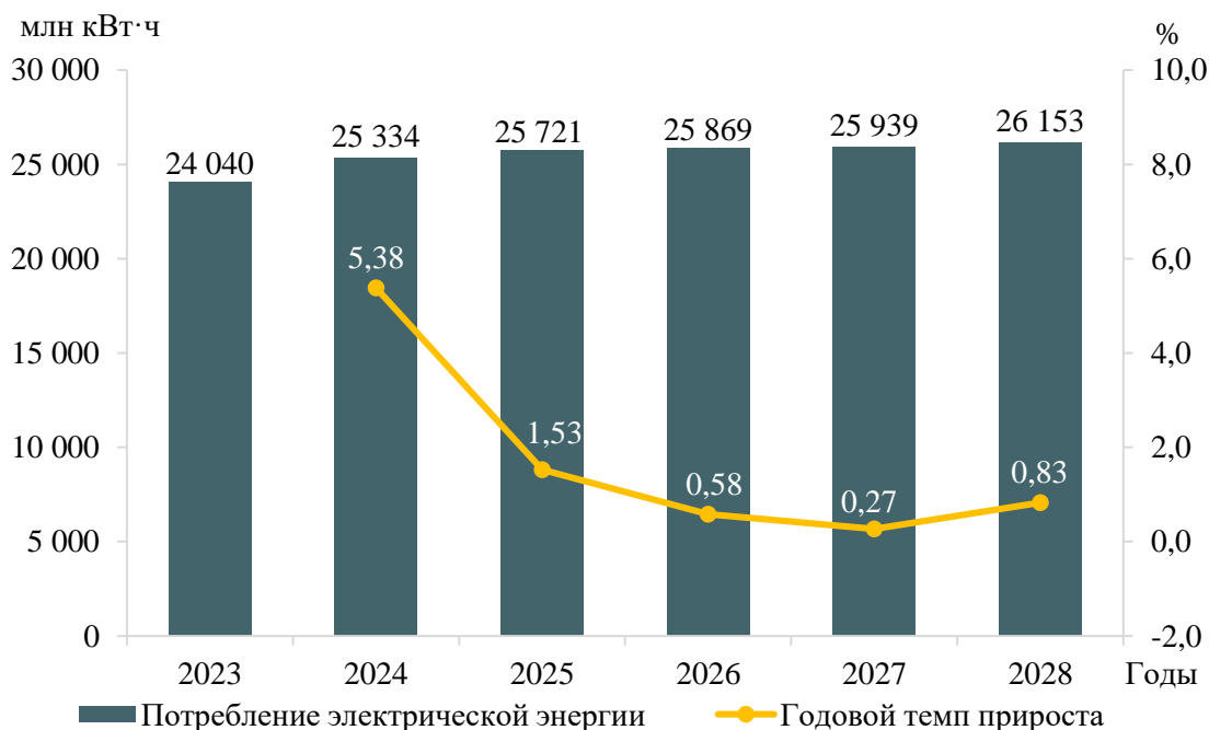
Рисунок 4 – Прогноз потребления электрической энергии энергосистемы Пермского края и годовые темпы прироста на период 2023–2028 годов
