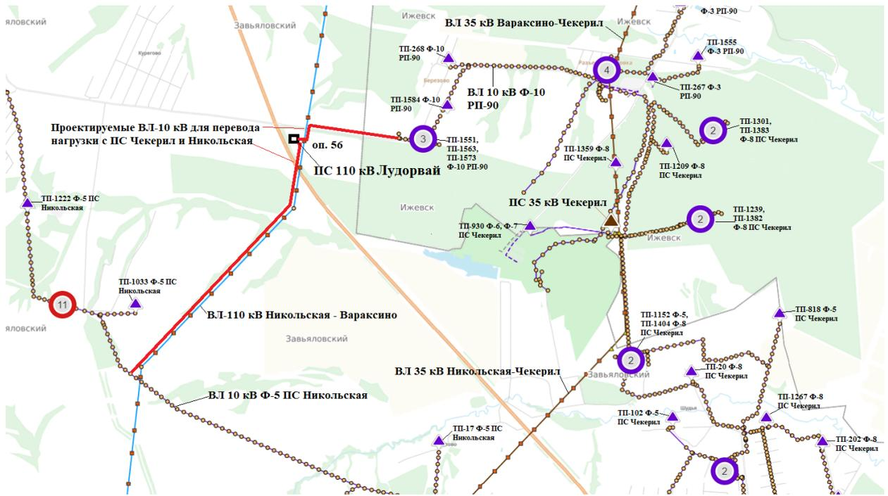
Рисунок 3 – Схема расположения новой ПС 110 кВ Лудорвай
