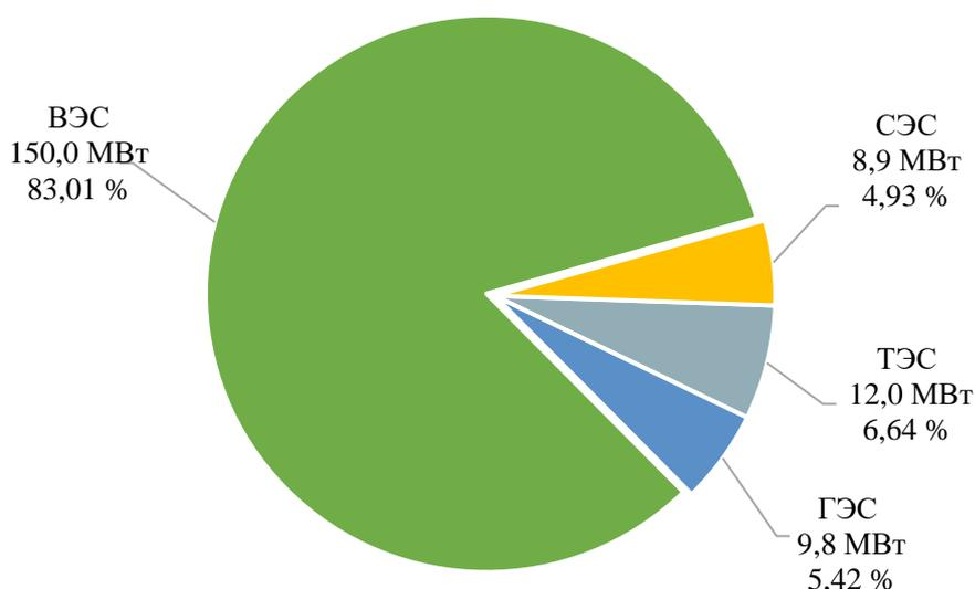
Рисунок 1 – Структура установленной мощности электростанций энергосистемы Республики Адыгея и Краснодарского края, расположенных на территории Республики Адыгея, по состоянию на 01.01.2024
