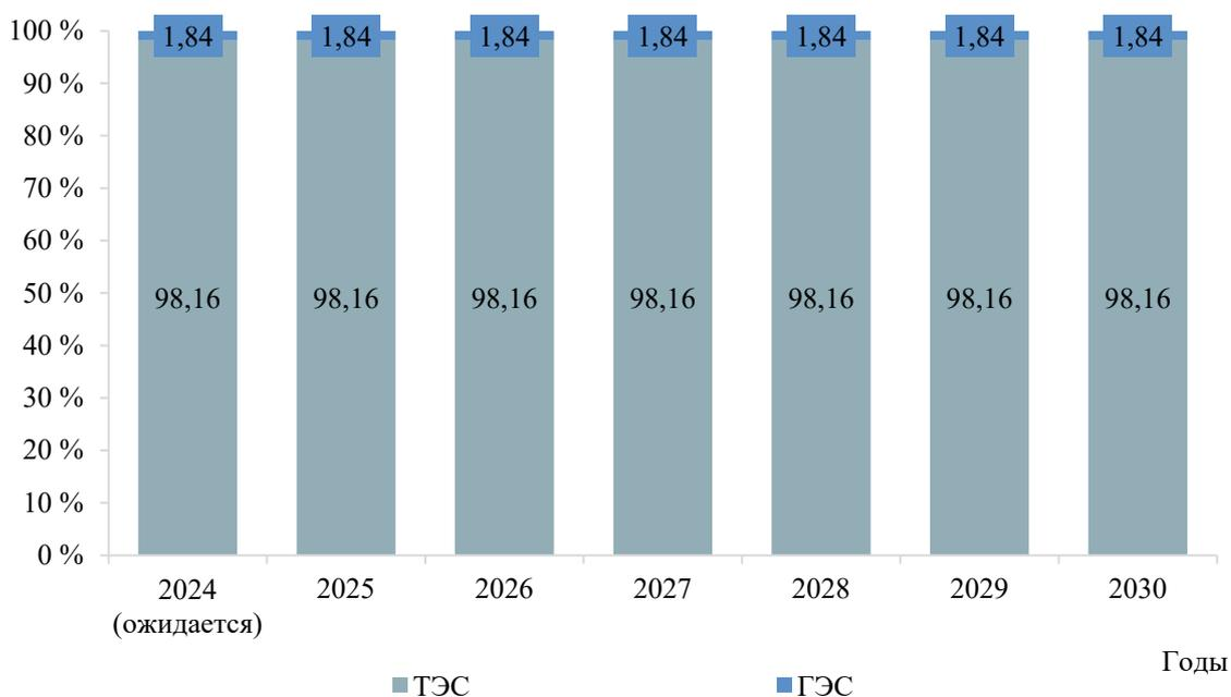
Рисунок 7 – Структура установленной мощности электростанций энергосистемы Вологодской области
