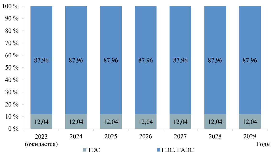
Рисунок 6 – Структура установленной мощности электростанций энергосистемы Карачаево-Черкесской Республики
