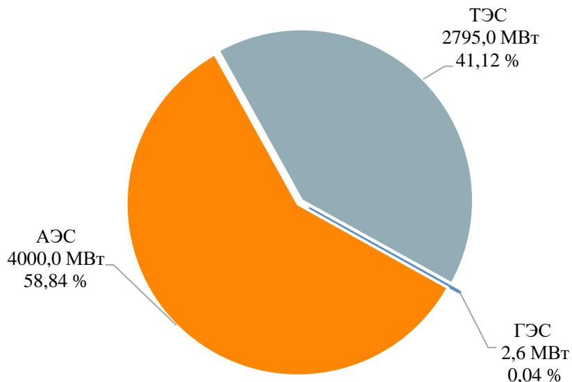
Рисунок 1 – Структура установленной мощности электростанций энергосистемы Тверской области по состоянию на 01.01.2023
