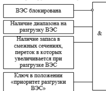
Блок расчета КДУ ВЭС при выборе приоритета разгрузки в пользу ВЭС
