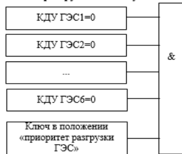
Блок расчета КДУ ВЭС при выборе приоритета разгрузки в пользу ГЭС
