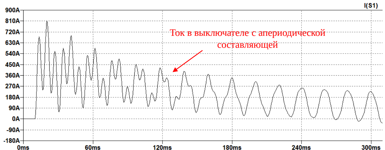
График изменения тока в выключателе В при постановке под напряжение ЛЭП и включенных линейных ШР
