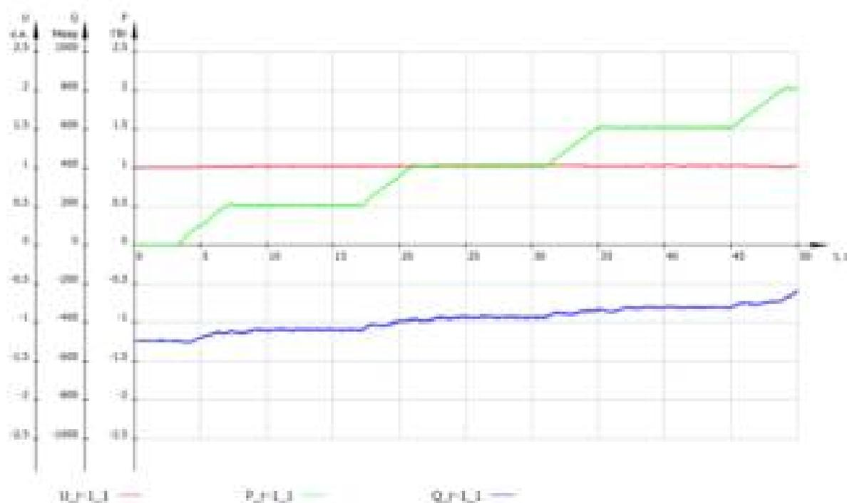
**Рисунок 35. Пример корректной работы АРВ сильного действия синхронного генератора (плавного входа в зону ОМВ) в статическом режиме при медленном увеличении активной мощности генератора**
