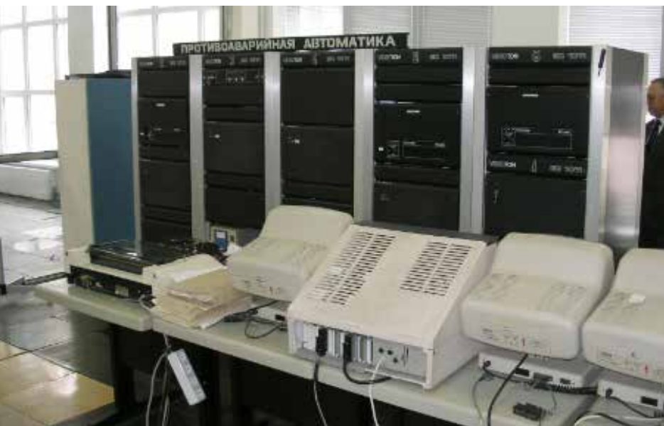
Для обработки информации и определения управляющих воздействий в ЦСПА ОЭС Урала до середины 2000-х использовали венгерские ЭВМ «Видеотон»
