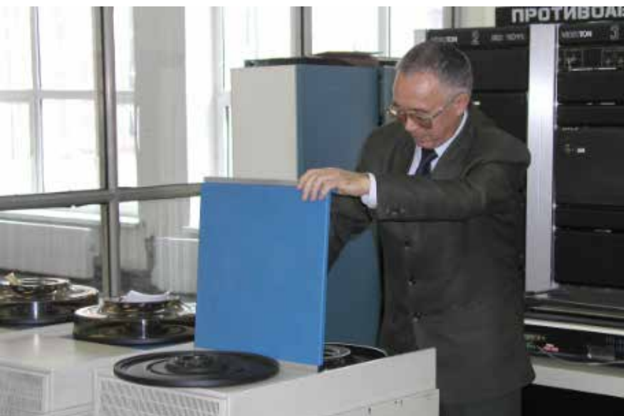
Перезарядка устройства ввода данных на ЭВМ «Видеотон» ЕС-1011
